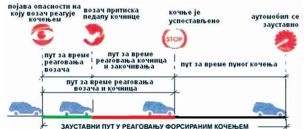
Приказ тока заустављања аутомобила кочењем којим возач реагује на појаву опасне препреке на путу испред аутомобила
